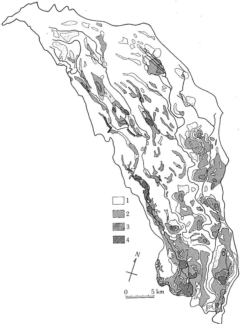
第 2 図 狩野川台風 (1958年 9 月) における中川流域の浸水状況 凡例: 1. 水深 25cm 未満, 2. 同 25cm~50cm 未満 3. 同 50cm~75cm 未満, 4. 同 75cm 以上 (科学技術庁資源局資料第40号, 中川流域低湿地の地形分類と土地利用, より作成)
