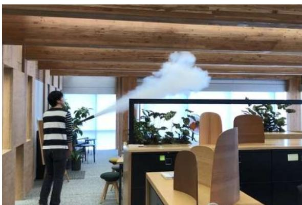
自然換気性能測定（CO<sub>2</sub> 散布）
