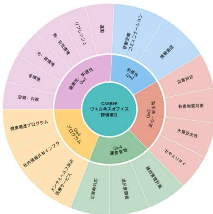
図1-3：CASBEE-ウェルネスオフィス評価項目<sup>15)</sup>
