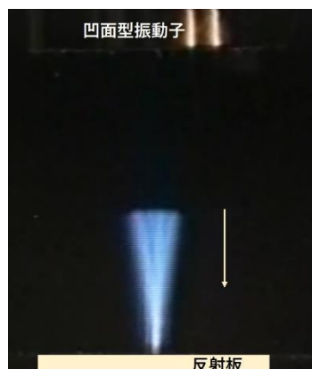
図 7.8 集束超音波が反射板に入射する瞬間の様子をシュリーレン法で撮影した例。(関西大山本健教授より提供)
