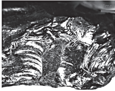
図 2-8 写真 2：ランダム線状痕 (極小まれ)
