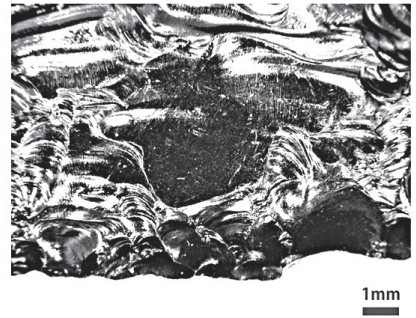
図 2-3 写真 2: ランダム線状痕(極小まれ)
