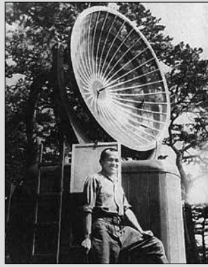
第5図 山田愿蔵と 潜望鏡探知用レーダー （20cm波） 出典：伴繁雄 『陸軍登戸研究所の真実』 （芙蓉書房出版，2001年）
