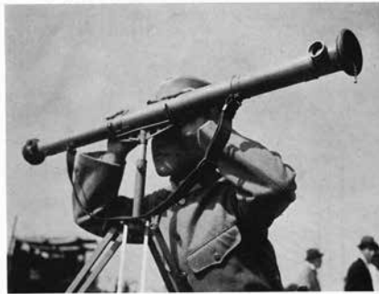
第 25 図 十纏対空双 眼鏡 (上), 一米対空 測遠機 (下)
