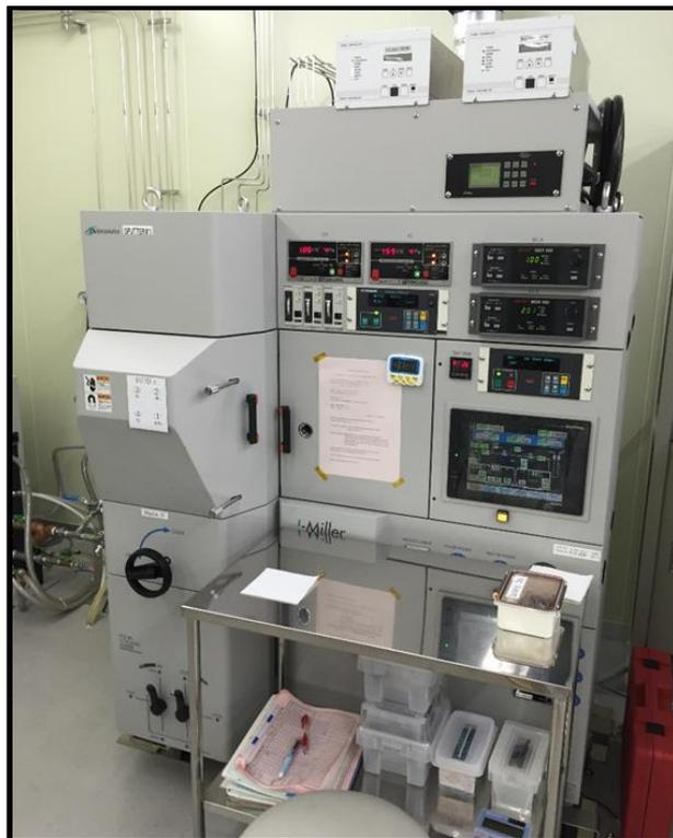
**Fig. 2-5** スパッタリング装置の外観写真
