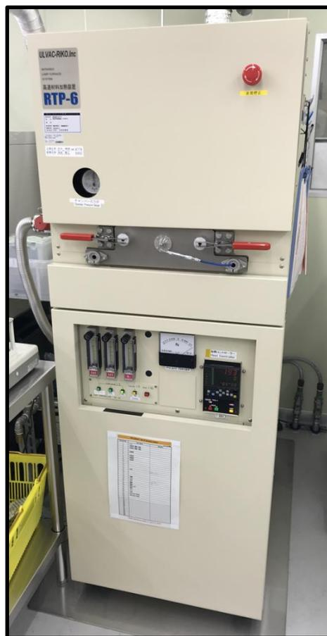
Fig. 2-7 RTA 装置の外観写真
