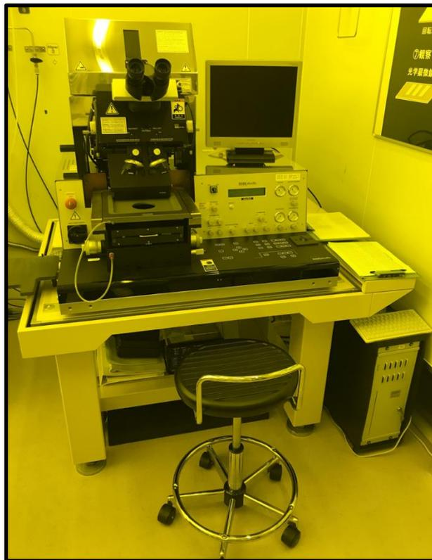
Fig. 2-11 マスクアライナー装置の外観写真
