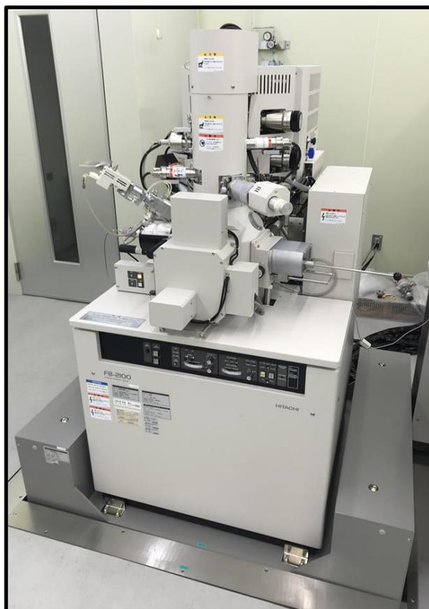
**Fig. 2-22** FIB 装置の外観写真
