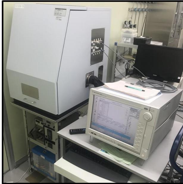
Fig. 2-24 C-V測定で使用したプローバの外観写真
