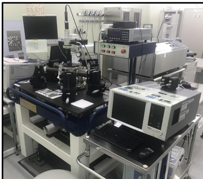
Fig. 2-23  $I$ - $V$  及び  $P$ - $E$  測定で使用したプローバの外観写真
