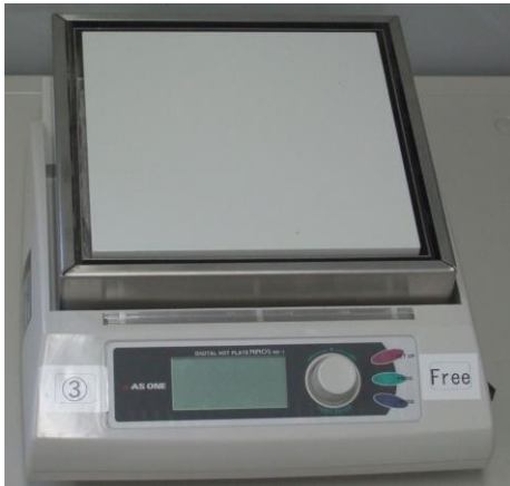
Fig. 2-25 ホットプレートの外観写真
