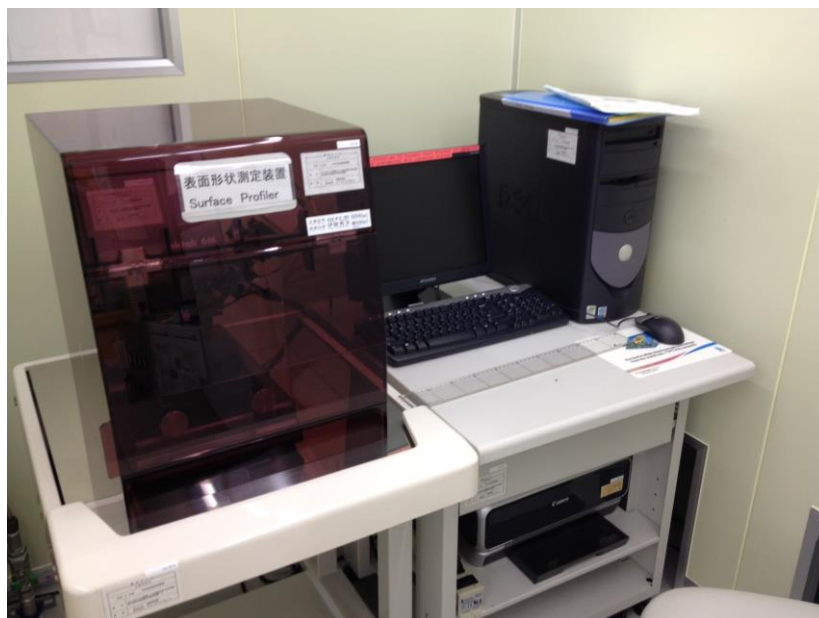
Fig.2-28 触針式段差計の外観写真
