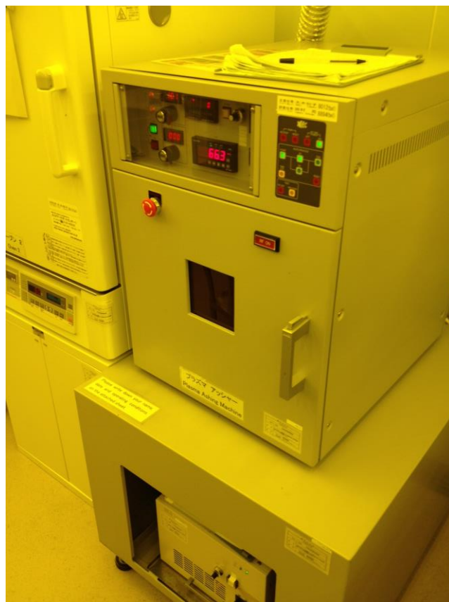
Fig. 2-2 プラズマアッシング装置の外観写真
