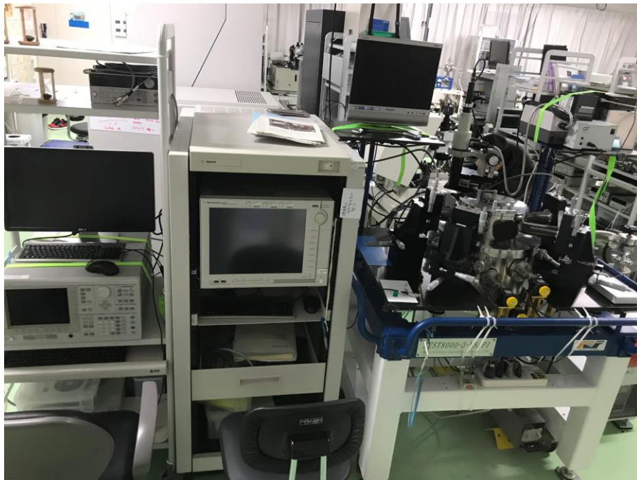
Fig. 2-57 半導体パラメータアナライザー及びプローバーの外観写真
