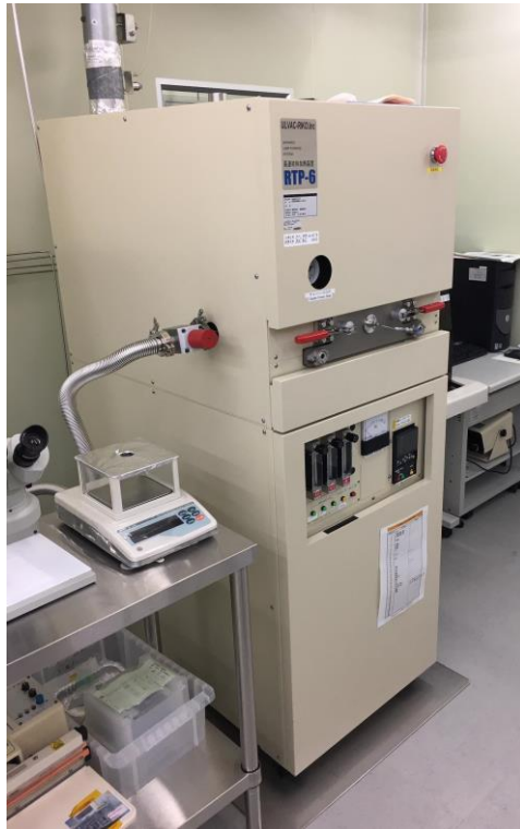
Fig. 2-22 6 インチ RTA 装置の外観写真
