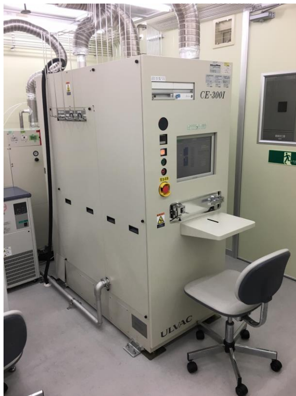
Fig. 2-19 ドライエッチング装置の外観写真
