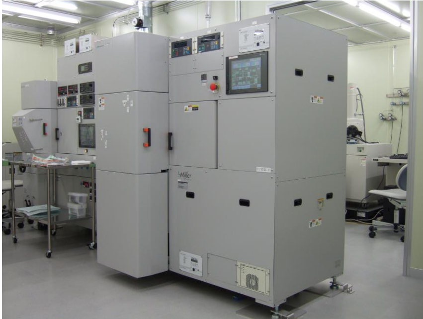
Fig. 2-4 マグネトロンスパッタリング装置の外観写真
