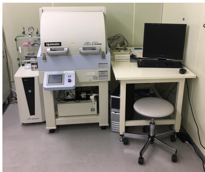
Fig. 2-40 AFM 装置の外観写真
