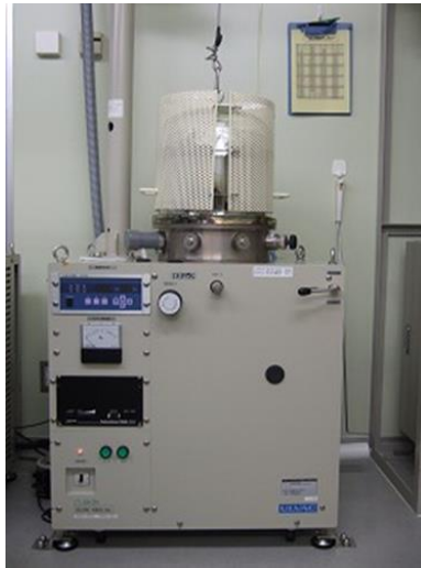
Fig. 2-7 抵抗加熱蒸着装置の外観写真
