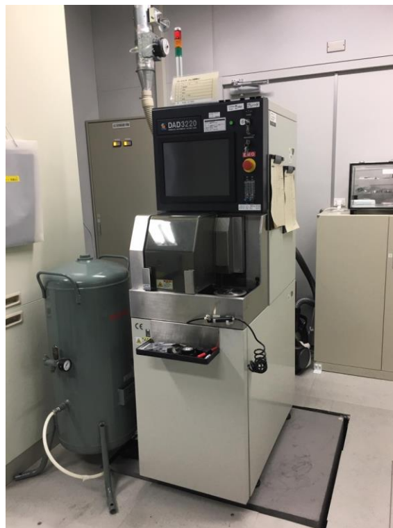
Fig. 2-1 ダイシング装置の外観写真
