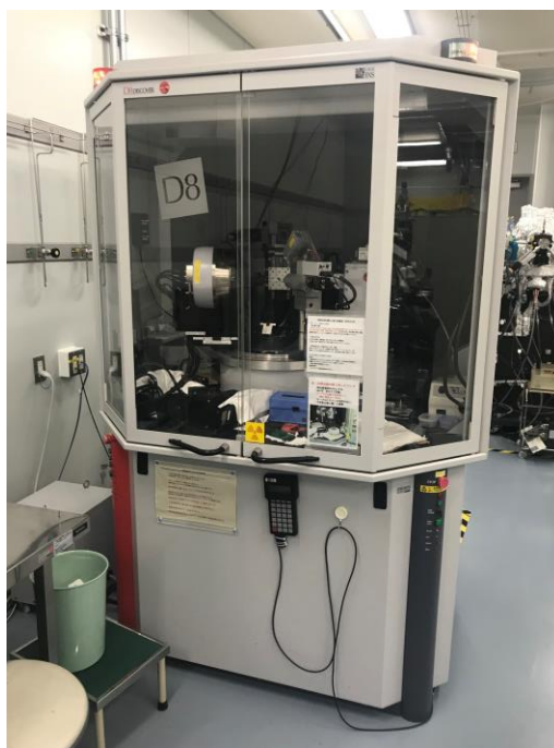
Fig. 2-33 XRD 装置の外観写真
