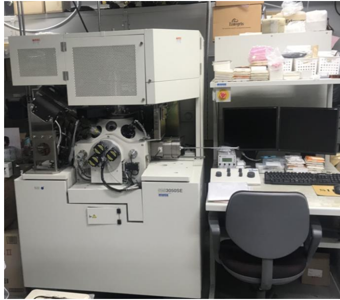
Fig. 2-35 断面TEM観察用の試料を作製したFIB装置
