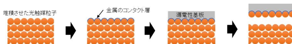
Fig. 1-8 粒子転写法の概略図
