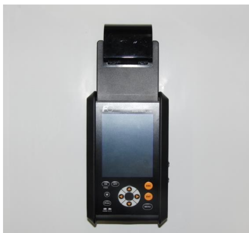
写真 3.1.1-1 流量計変換器
