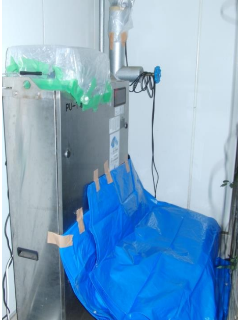
写真 3.1.1-9 計測装置の雨対策（全階）
