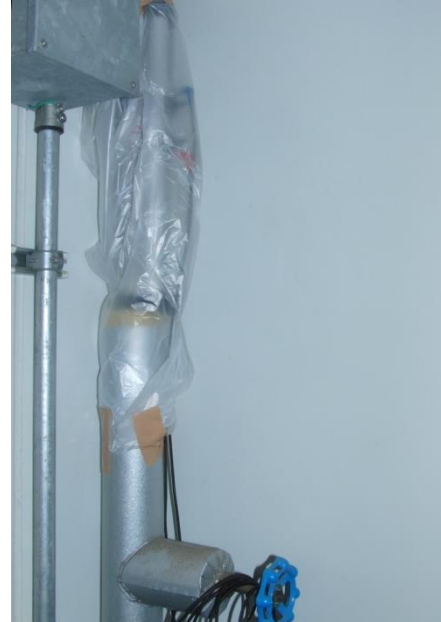
写真 3.1.1-9 計測装置の雨対策（全階）
