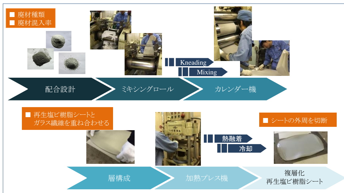
図4-5-1 複層化再生塩ビ樹脂シートの作製フロー
