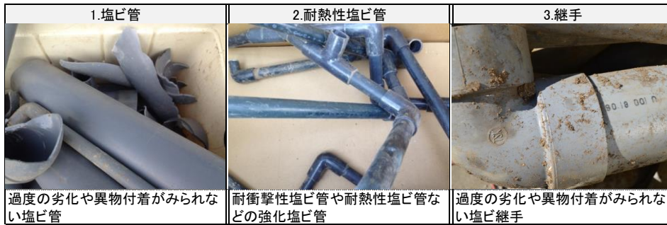
図 2-2-4 解体現場由来廃材調査におけるリサイクル適材品に分類した例
