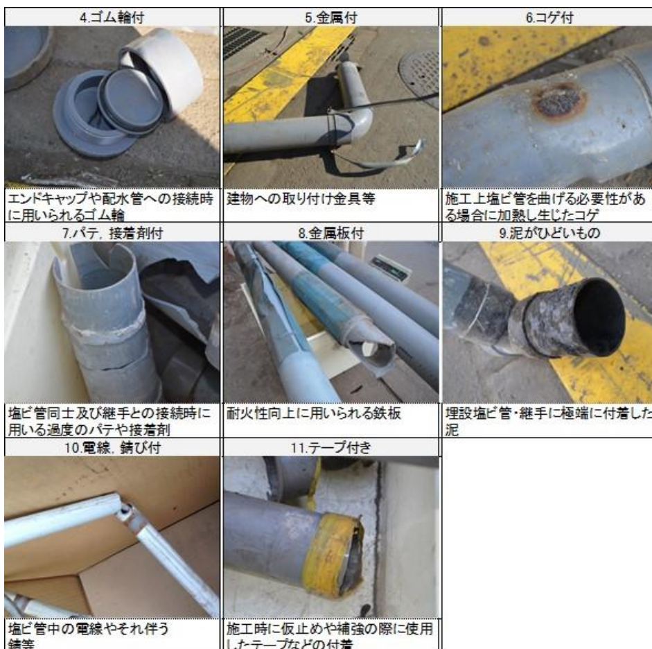
図 2-2-5 解体現場由来廃材調査におけるリサイクル適材品（要簡易処理）に分類した例
