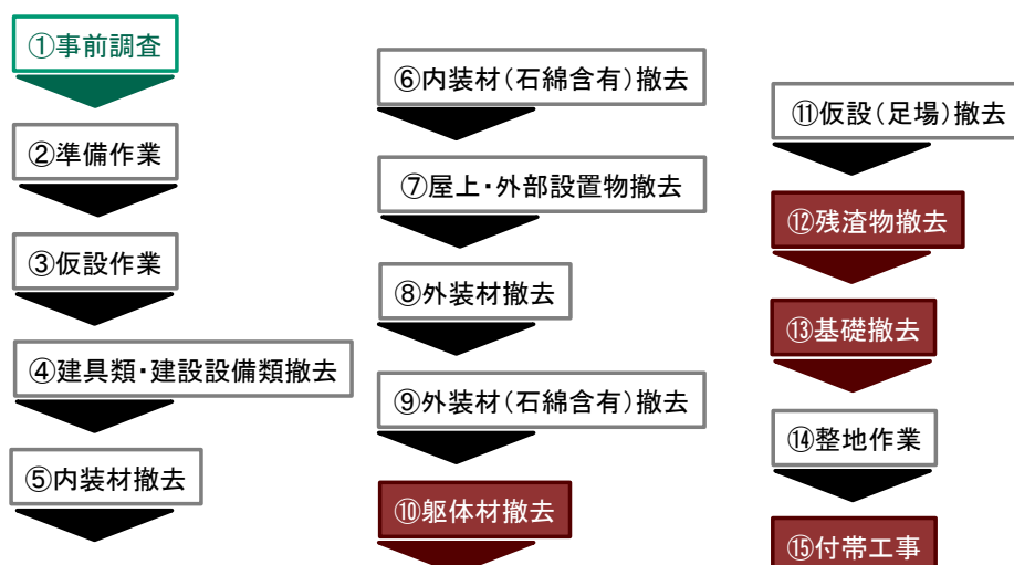
図 2-2-2 解体工事手順および調査対象箇所
