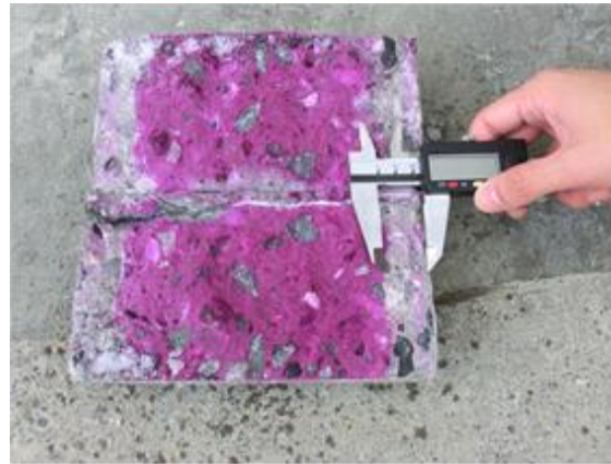
図 5-2-3 中性化深さ計測方法
