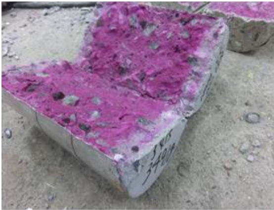
図 5-2-2 試験体割裂の様子
