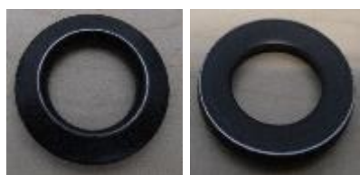
(a) 皿ばね座金(1種：重荷重用 H タイプ呼び 16)
