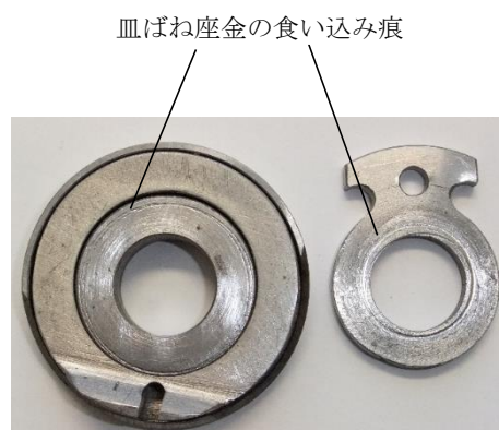
図 6.15 皿ばね座金の食い込み痕
