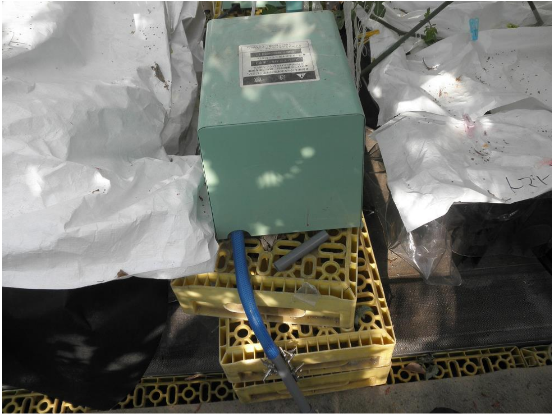
写真 24 第 4 章で用いたエアーポンプ（㈱大晃機械工業製,DF-60）
