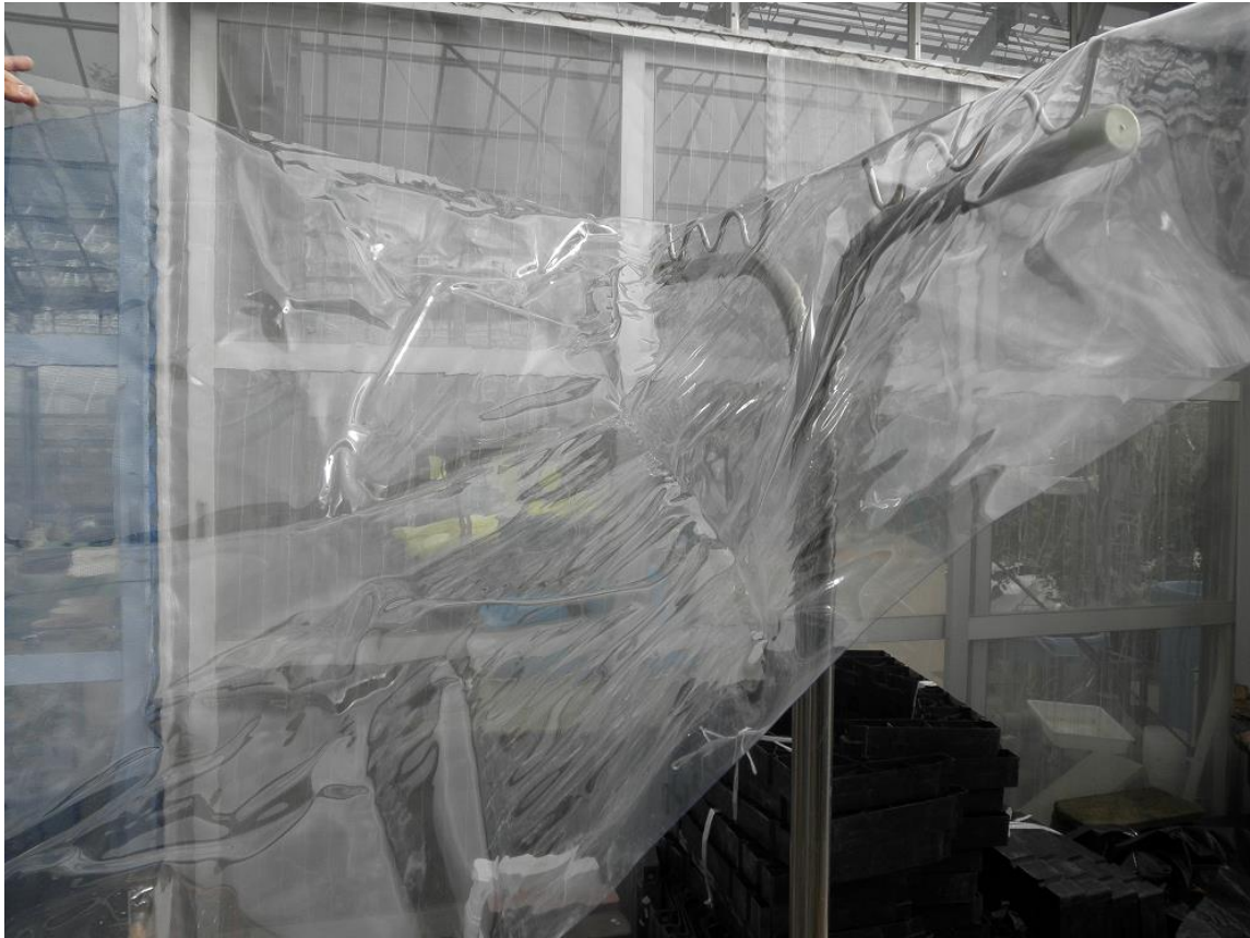
写真 21 第 4 章で用いた水耕シート（㈱アキレス製，アキレスマジキリⅡ.厚さ 0.5mm）
