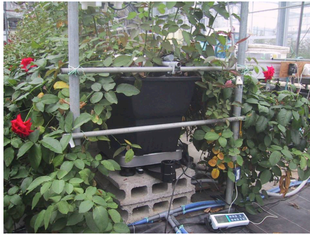
写真 4-1 重量法によるバラのみかけの蒸発散量測定装置
