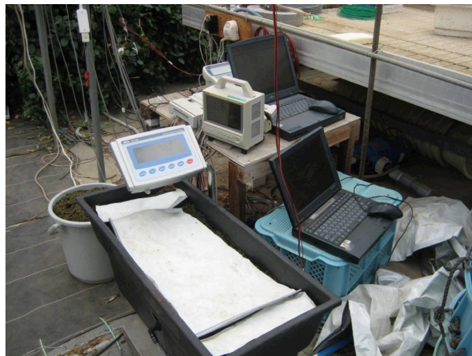
写真 4-2 培地表面被覆による地表からの蒸発散量測定装置
