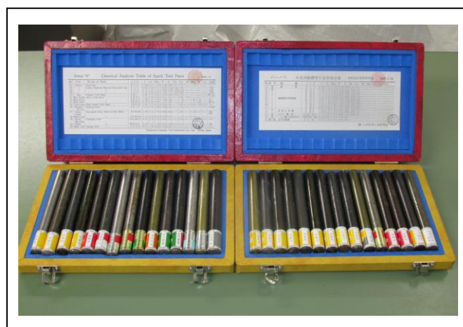
(b) 成分表付き火花試験標準品(炭素鋼, 合金鋼)
