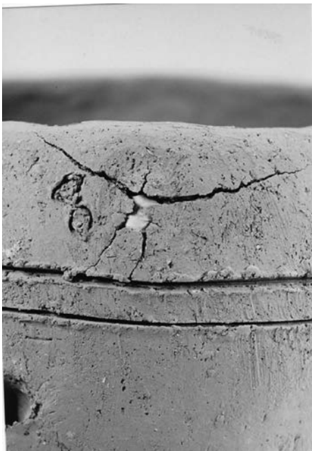
図 26 マメの膨張によってひび割れの生じた例 (焼成実験から。縮尺約 1/1)
