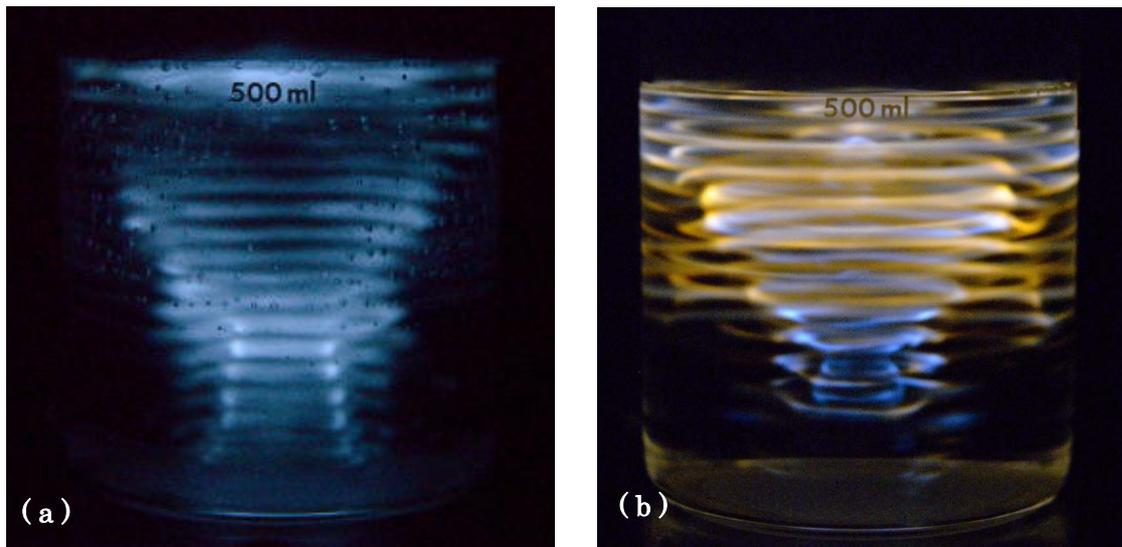
図 4 円筒フラスコ内でのソノルミネセンス写真．試料は (a)水，(b)濃度 10mM の SDS 水溶液である．フラスコ底から水面に向かって 150 kHz の超音波を照射．発光する気泡が定在波の腹にトラップされるため，縞状に光って見える．(b)は Y.Hayashi and P.-K. Choi, *Ultrason. Sonochem.* 23(2015) 333-338.より引用．Copyright (2015), Elsevier Publishing.
