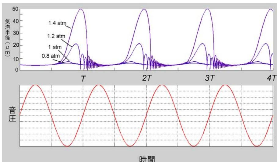
図 1. 気泡の膨張収縮振動の計算結果. 図上は周波数 24kHz, 初期半径  $5 \mu\text{m}$ , 音圧 0.8~1.4 気圧での気泡半径の時間変化. 図下は音圧の時間変化を表す.  $T$  は音波周期である.
