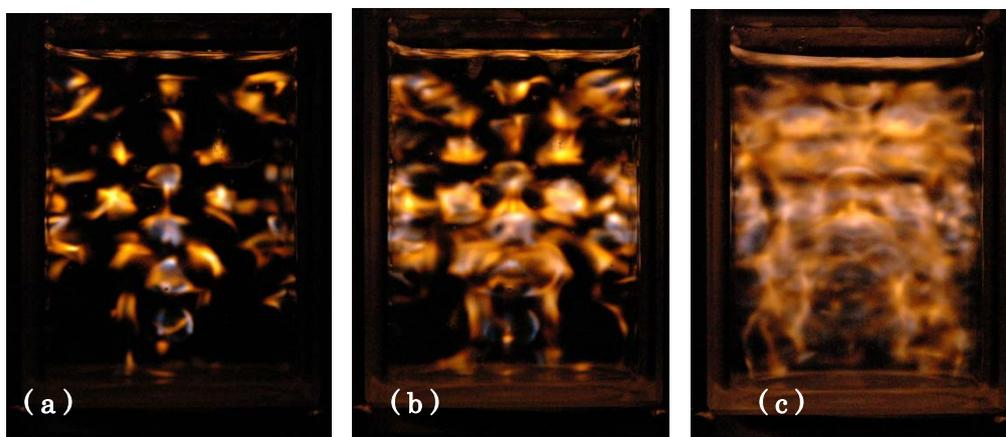
図 5 . NaCl 水溶液を入れた角柱容器中でのソノルミネセンス写真．周波数は約 100 kHz．オレンジは Na 原子 (589 nm) からの発光．写真 (a) は超音波強度が弱い場合で，3 次元定在波の腹に気泡がトラップされている．(b) から (c) と徐々に超音波が強くなるにつれてトラップ位置が節方向にずれるため分布がぼやけている．
